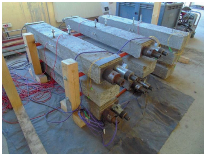
Rys. 12.36. Belki do badania skurczu i pęcznienia ułożone w przyrządach (badania własne [83])
