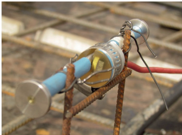
Rys. 12.11. Widok wgłębny przetwornika odkształceń (a) oraz siłomierza na cięgnię sprężającym (b) (fot. aut.)
