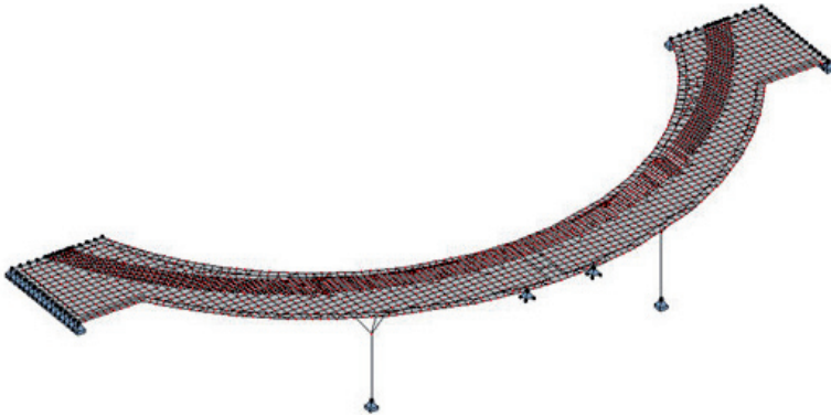
Rys. 13.17. Model antresoli w systemie MES (projekty własne [138, 140])
