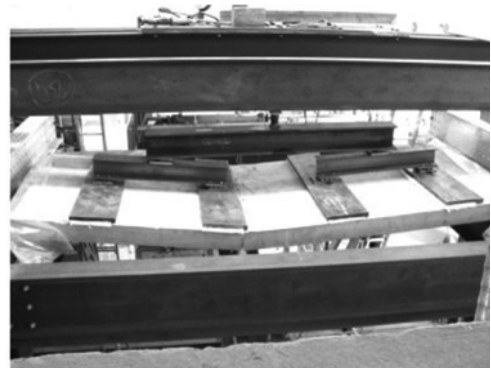
Rys. 11.23. Widok zbrojenia stref końcowych i sprężenia w formie (a) oraz zniszczonej płyty na stanowisku badawczym (b) [11]
