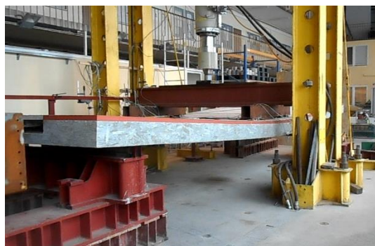
Rysunek 20: Wykonana płyta prototypowa (a), płyta podczas badań (b)
