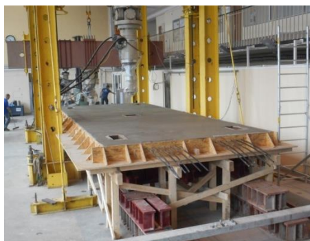
Rysunek 20: Wykonana płyta prototypowa (a), płyta podczas badań (b)
