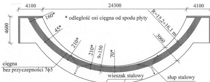
Rysunek 8: Rzut projektowanej antresoli wraz z układem cięgień sprężających
