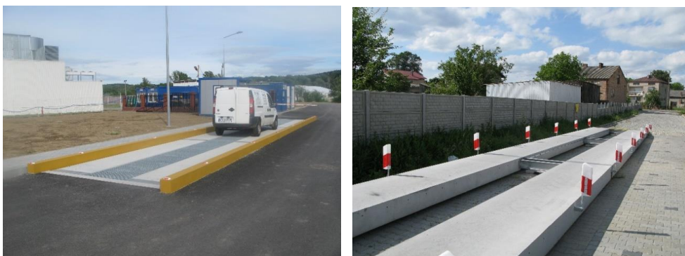
Rys. 68 Waga samochodowa 60 tonowa w wersji zagłębionej i wyniesionej.
