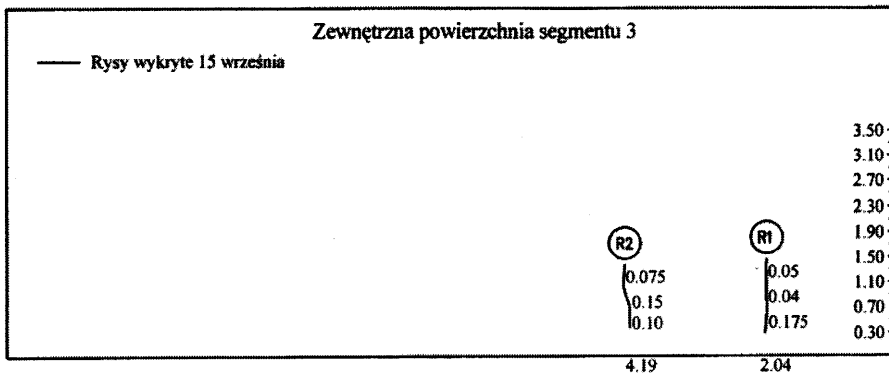
Rys. 16. Układ rys na zewnętrznej powierzchni segmentu 3
